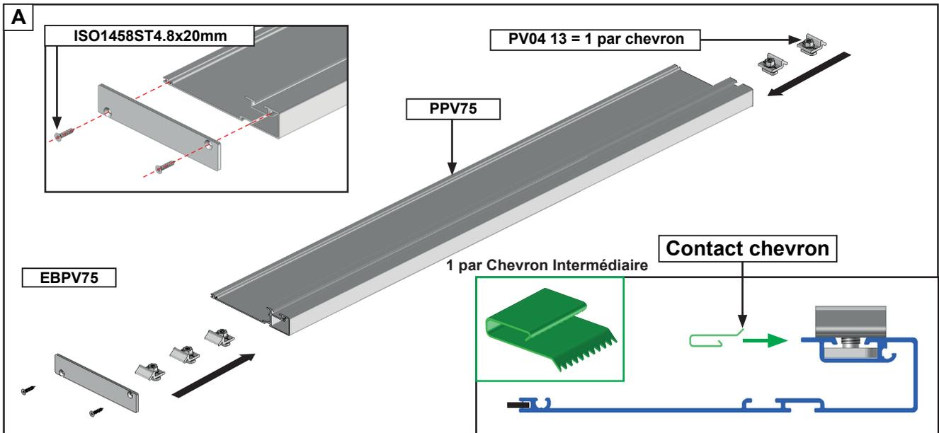
**B** Réalisez les mêmes opérations du paragraphe 21 pour la pose du 2nd PPV75 et le plaquer contre le 1er.
