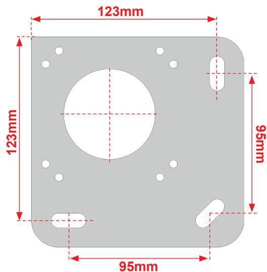
Fixez les platines au niveau de chaque plot béton réalisé auparavant par deux vis minimum.
