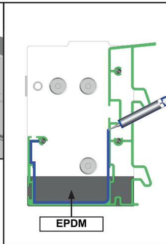
**Note :** étanchéité à réaliser si non présence du joint EPDM.
