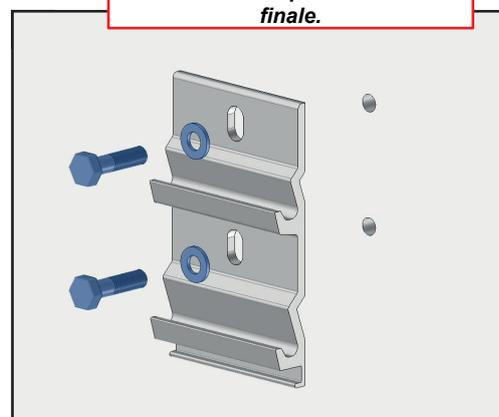
**Adapter la fixation à la nature du mur. Fixation avec des vis Ø10mm. Kit de vis et rondelle non fournis. Dans le cas d'installation à l'aide d'un kit de scellement chimique, se référer aux instructions d'utilisation du produit utilisé.**
